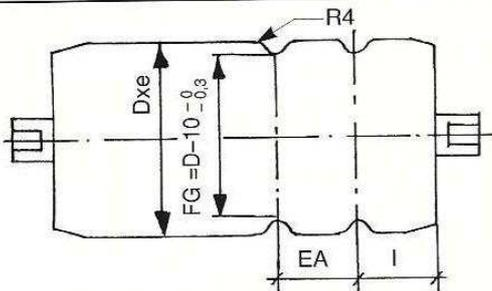
Entraînement de rouleaux pour charges isolées légères - à 1 gorge (avec arbre d'entraînement) ou à 2 gorges (entraînement en cascade) à prévoir de préférence sur rouleaux équipés de roulements normalisés ou sur des rouleaux gravitaires, sur tubes bruts ou électro-zingués.
