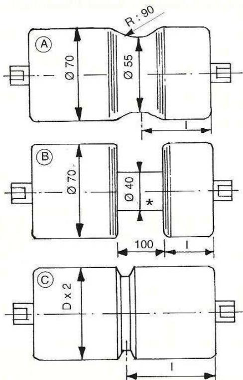
Ci-contre : formes utilisées pour faciliter la détection d'objets par cellule située entre deux rouleaux à pas serré (très utilisé en cartonnerie).
